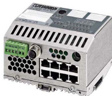
Abbildung 5.3: Der FL SWITCH SMCS 8GT
