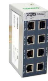
Abbildung 5.2: Der FL SWITCH SFN 8GT
